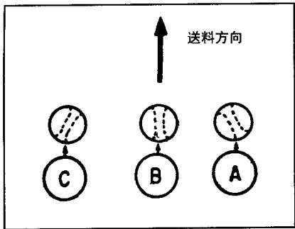
装缝针时应使对应的针孔与缝料方向在一直线上，如图 B特别是在使用化纤线时，针孔方向请勿使成为图C所示的方向。
