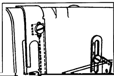
针线挑线在最下点位置，如图中所示面线线圈便增大，同时收紧针线圈的作用。
